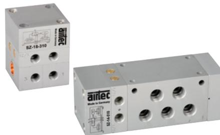
Das Ventil schaltet, wenn zwei Eingangssignale bei 12 innerhalb 0,5 s ankommen. Nach Löschen eines oder beider Signale stellt der Kolben zurück. Wenn die Eingangssignale nicht innerhalb 0,5 s ankommen, schaltet das Ventil nicht. Zum Wiedereinschalten müssen vorher beide Signale gelöscht sein.
