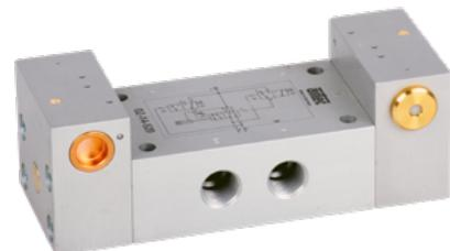
5/2-Wege Oszillationsventil mit integrierten Steuerleitungen und pneumatischer Notstartfunktion. Diese verhindert eine undefinierte Mittelstellung des Ventils und gewährleistet ein sicheres Anlaufen. Beim Betrieb ist die Verwendung von Drossel-Schalldämpfern in den Abluftanschlüssen erforderlich. Damit kann die Oszillationsgeschwindigkeit eingestellt werden.
