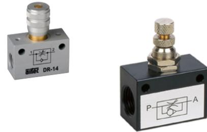
Die in Drosselrichtung strömende Luftmenge kann durch Verstellen der Drosselspindel reguliert werden. Gegen Drosselrichtung strömt die Luft ungedrosselt über ein Rückschlagventil. Die Drosselspindel ist gegen ungewollte Verstellung durch einen Reibring in der Verstellbuchse gesichert, bei dem Ventil DR-10 erfolgt die Sicherung durch eine Kontermutter. Die Reibkraft ist so bemessen, daß die Spindel von Hand leicht gedreht werden kann.
