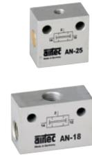
Am Ausgang 2 erscheint ein Signal, wenn an den Eingängen 12 und 14 zugleich Signale anstehen. Bei unterschiedlichen Drücken gelangt der niedrigere Druck zum Ausgang. Das UND-Glied hat als passives Element keine eigene Entlüftung. Nach Löschen eines oder beider Eingangssignale wird über die vorgeschalteten Signalglieder entlüftet.
