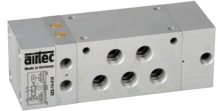
Diese Zwei-Signal-Steuerung hat außer den beiden Signaleingängen bei 12 noch den Signalanschluss 14. Signal auf 14 schaltet die Zwei-Signal-Steuerung wie ein normales 5/2-Wege-Ventil. Das Ventil schaltet, wenn zwei Eingangssignale bei 12 innerhalb 0,5 s ankommen. Nach Löschen eines oder beider Signale stellt der Kolben zurück. Wenn die Eingangssignale nicht innerhalb 0,5 s ankommen, schaltet das Ventil nicht. Zum Wiedereinschalten müssen vorher beide Signale gelöscht sein.
