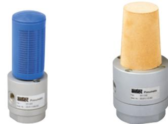
Vakuum-Ejektor nach dem Venturi-Prinzip an einem Ringspalt. Der Schalldämpfer gehört zum Lieferumfang. Die Baureihe HF ist ausgelegt zum Erreichen eines hohen Vakuumdurchflusses.
