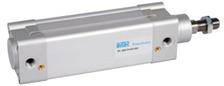
Doppeltwirkender Pneumatikzylinder, beidseitig mit einstellbarer, pneumatischer Endlagendämpfung. Mit Positionserkennung zur berührungslosen Stellungsabfrage mit Zylinderschaltern. Sonderhublängen sind auf Wunsch lieferbar.
