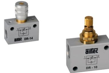
Die in Drosselrichtung strömende Luftmenge kann durch Verstellen der Drosselspindel reguliert werden. Gegen Drosselrichtung strömt die Luft ungedrosselt über ein Rückschlagventil. Die Drosselspindel ist gegen ungewollte Verstellung durch einen Reibring in der Verstellbuchse gesichert, bei dem Ventil DR-10 erfolgt die Sicherung durch eine Kontermutter. Die Reibkraft ist so bemessen, daß die Spindel von Hand leicht gedreht werden kann.
