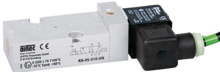
Damit entsprechen sie der Gerätekategorie 2 und können ab der Zone 1 bzw. 21 eingesetzt werden. Für den Einsatz in explosionsgefährdeter Umgebung ist zusätzlich die Gerätekategorie der verwendeten Magnetspule zu beachten. Für die Baugruppe ist immer die niedrigste Gerätekategorie der Komponenten zu verwenden.
