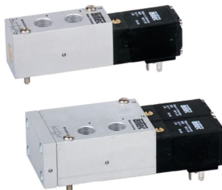
Elektrisch betätigtes Kolbenschieber-Ventil. Nach Zuschalten der Spannung wird das Ventil umgesteuert. Die Ventile sind mit einer rastenden Handhilfsbetätigung ausgestattet. Die Betätigung erfolgt mittels Schraubendreher.
