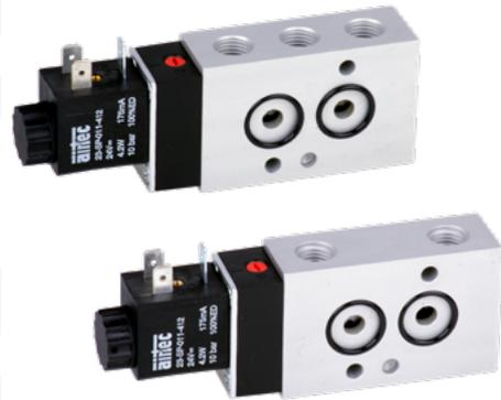
Elektrisch betätigtes Kolbenschieber-Ventil. Nach Zuschalten der Spannung wird das Ventil umgesteuert. Die Ventile sind mit einer rastenden Handhilfsbetätigung ausgestattet. Die Betätigung erfolgt mittels Schraubendreher. Befestigungsschrauben, Codierstift und O-Ringe gehören zum Lieferumfang.
