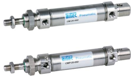
Doppelwirkender Pneumatikzylinder mit Dämpfungsscheiben in den Endlagen und Positionserkennung zur berührungslosen Stellungsabfrage mit Zylinderschaltern. Der Zylinder ist auch mit einstellbarer, pneumatischer Endlagendämpfung lieferbar. Zylinderkopf und -boden sind mit dem Zylinderrohr durch Rollieren verbunden.
