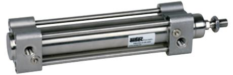
Doppeltwirkender Pneumatikzylinder aus Edelstahl, beidseitig mit einstellbarer, pneumatischer Endlagendämpfung. Mit Positionserkennung zur berührungslosen Stellungsabfrage mit Zylinderschaltern. Sonderhublängen sind auf Wunsch lieferbar.
