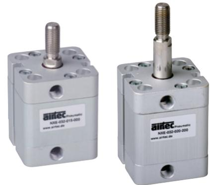
Einfachwirkender Pneumatikzylinder mit integrierten Dämpfungsscheiben. Mit Positionserkennung zur berührungslosen Stellungserkennung mit Zylinderschaltern.
