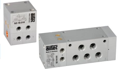
Das Ventil schaltet, wenn zwei Eingangssignale bei 12 innerhalb 0,5 s ankommen. Nach Löschen eines oder beider Signale stellt der Kolben zurück. Wenn die Eingangssignale nicht innerhalb 0,5 s ankommen, schaltet das Ventil nicht. Zum Wiedereinschalten müssen vorher beide Signale gelöscht sein.
