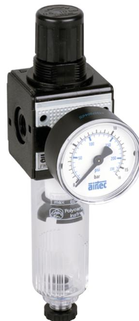
Kombination aus Membrandruckregler mit Sekundärentlüftung und Sinterfilter nach dem Zentrifugalkraft-Prinzip.
