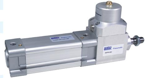
Doppeltwirkender Pneumatikzylinder, beidseitig mit einstellbarer, pneumatischer Endlagendämpfung. Mit Positionserkennung zur berührungslosen Stellungsabfrage mit Zylinderschaltern.
