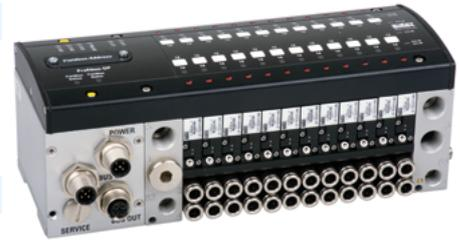
Ventil-/Grundplattensystem mit elektrischem Sammelanschluss, integrierter LED- Anzeige und Schutzbeschaltung. Das Ventil-Terminal kann beliebig mit 2 x 3/2-Wege-Ventilen, einem 5/2- oder 5/3-Wege-Ventil auf jeder Station bestückt werden. Alle Anschlüsse sind von der Vorderseite zugänglich.
