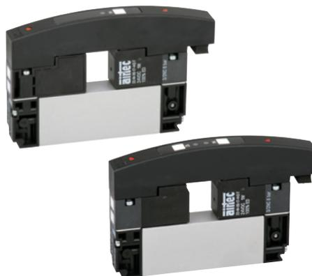
Elektrisch betätigtes Kolbenschieber-Ventil. Nach Zuschalten der Spannung wird das Ventil umgesteuert. Die Ventile sind mit einer tastenden und rastenden Handhilfsbetätigung ausgestattet. Die Betätigung erfolgt über den Terminaldeckel mittels Schraubendreher.
