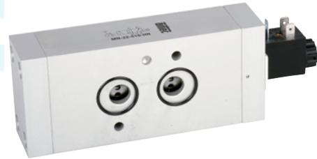
Elektrisch betätigtes Kolbenschieber-Ventil. Nach Zuschalten der Spannung wird das Ventil umgesteuert. Die Ventile sind mit einer rastenden Handhilfsbetätigung ausgestattet. Die Betätigung erfolgt mittels Schraubendreher. Befestigungsschrauben, Codierstift und O-Ringe gehören zum Lieferumfang.
