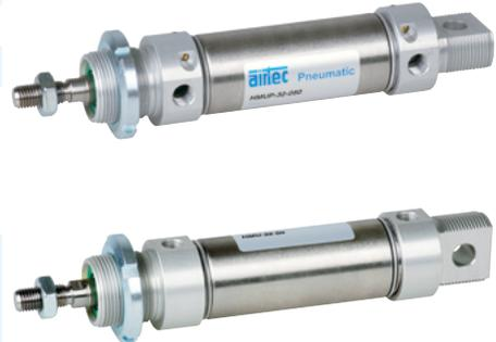
Doppelwirkender Pneumatikzylinder mit Dämpfungsscheiben in den Endlagen und Positionserkennung zur berührungslosen Stellungsabfrage mit Zylinderschaltern. Der Zylinder ist auch mit einstellbarer, pneumatischer Endlagendämpfung lieferbar. Zylinderkopf und -boden sind mit dem Zylinderrohr durch Rollieren verbunden.
