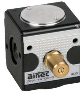
Anfahrventil zum langsamen Druckaufbau in Druckluftsystemen. Die Betätigung erfolgt durch den Sekundärdruck. Nach Erreichen von 50% des Ausgangsdrucks schaltet das Ventil komplett durch. Die Füllzeit ist einstellbar.
