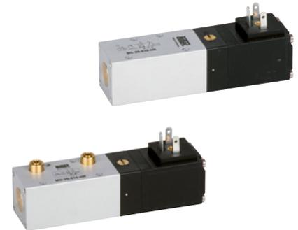
Elektrisch betätigtes Kolbenschieber-Ventil. Nach Zuschalten der Spannung wird das Ventil umgesteuert. Die Ventile sind mit einer rastenden Handhilfsbetätigung ausgestattet. Die Betätigung erfolgt mittels Schraubendreher. Die Befestigungsschrauben und die Dichtungen für die Grundplattenmontage gehören zum Lieferumfang.
