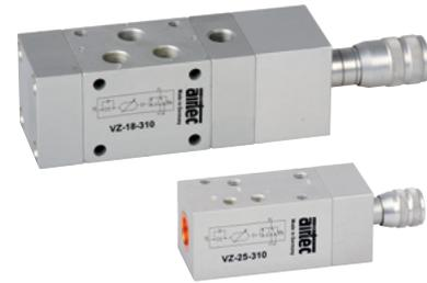
Pneumatisch betätigtes Kolbenschieber-Ventil mit einstellbarer Einschaltverzögerung. Durch Druckbeaufschlagung wird das Ventil nach Ablauf der eingestellten Zeit umgesteuert. Nach Löschen des Signals wird das Ventil sofort zurück gestellt. Druckanschluss bei 1 ergibt die Funktion „Ruhestellung geschlossen“, Druckanschluss bei 3 die Funktion „Ruhestellung offen“.
