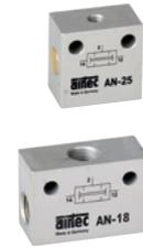
Am Ausgang 2 erscheint ein Signal, wenn an den Eingängen 12 und 14 zugleich Signale anstehen. Bei unterschiedlichen Drücken gelangt der niedrigere Druck zum Ausgang.
