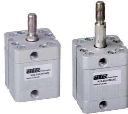
Einfachwirkender Pneumatikzylinder mit integrierten Dämpfungsscheiben. Mit Positionserkennung zur berührungslosen Stellungsbefragung mit Zylinderschaltern.
