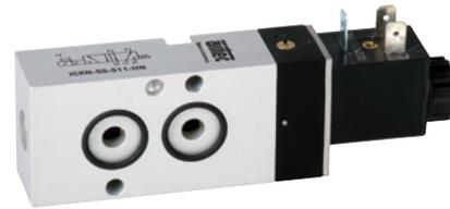
Elektrisch betätigtes Kolbenschieber-Ventil. Nach Zuschalten der Spannung wird das Ventil umgesteuert. Die Ventile sind mit einer rastenden Handhilfsbetätigung ausgestattet. Die Betätigung erfolgt mittels Schraubendreher. Befestigungsschrauben, Codierstift und O-Ringe gehören zum Lieferumfang.
