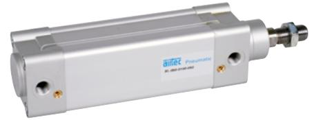
Doppelwirkender Pneumatikzylinder, beidseitig mit einstellbarer, pneumatischer Endlagendämpfung. Mit Positionserkennung zur berührungslosen Stellungsabfrage mit Zylinderschaltern. Sonderhublängen sind auf Wunsch lieferbar.
