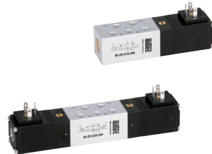
Elektrisch betätigtes Kolbenschieber-Ventil. Nach Zuschalten der Spannung wird das Ventil umgesteuert. Die Ventile sind mit einer rastenden Handhilfsbetätigung ausgestattet. Die Betätigung erfolgt mittels Schraubendreher.
