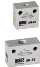
Am Ausgang 2 erscheint ein Signal, wenn an den Eingängen 12 und 14 zugleich Signale anstehen. Bei unterschiedlichen Drücken gelangt der niedrigere Druck zum Ausgang.
