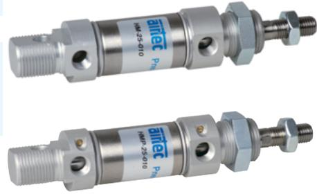
Doppelwirkender Pneumatikzylinder mit Dämpfungsscheiben in den Endlagen und Positionserkennung zur berührungslosen Stellungsabfrage mit Zylinderschaltern. Der Zylinder ist auch mit einstellbarer, pneumatischer Endlagendämpfung lieferbar. Zylinderkopf und -boden sind mit dem Zylinderrohr durch Rollieren verbunden. Sonderhublängen sind auf Wunsch lieferbar.
