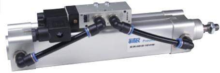
Doppeltwirkender Pneumatikzylinder, beidseitig mit einstellbarer, pneumatischer Endlagendämpfung. Mit Positionserkennung zur berührungslosen Stellungenabfrage mit Zylinderschaltern. Sonderhublängen sind auf Wunsch lieferbar.
