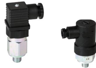
Einstellbare Membran-Druckschalter. Die Schalter sind voreingestellt auf 4 bar. Dieser Wert kann in den Grenzen des Einstellbereiches verändert werden. Die Lieferung erfolgt inklusive Schutzkappe (PE-18) bzw. Anschlussstecker (PE-14).
