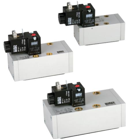
Elektrisch betätigtes Kolbenschieber-Ventil. Nach Zuschalten der Spannung wird das Ventil umgesteuert. Die Ventile sind mit einer rastenden Handhilfsbetätigung ausgestattet. Die Betätigung erfolgt mittels Schraubendreher.
