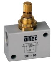
Die in Drosselrichtung strömende Luftmenge kann durch Verstellen der Drosselspindel reguliert werden. Gegen Drosselrichtung strömt die Luft ungedrosselt über ein Rückschlagventil. Die Drosselspindel ist gegen ungewollte Verstellung durch einen Reibring in der Verstellbuchse gesichert, bei dem Ventil DR-10 erfolgt die Sicherung durch eine Kontermutter. Die Reibkraft ist so bemessen, daß die Spindel von Hand leicht gedreht werden kann.
