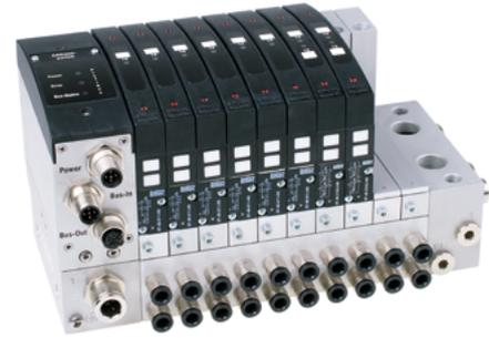
Ventil-/Grundplattensystem mit elektrischem Sammelanschluss, integrierter LED- Anzeige und Schutzbeschaltung. Das Ventil-Terminal kann beliebig mit 2 x 3/2-Wege-Ventilen, einem 5/2- oder 5/3-Wege-Ventil auf jeder Station bestückt werden. Alle Anschlüsse sind von der Vorderseite zugänglich.
