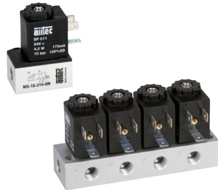
Elektrisch betätigtes Sitzventil. Nach Zuschalten der Spannung wird das Ventil umgesteuert. Die Ventile sind mit einer rastenden Handhilfsbetätigung ausgestattet. Die Betätigung erfolgt mittels Schraubendreher.
