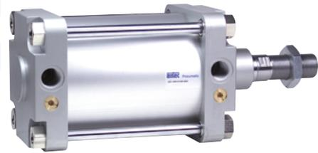
Doppelwirkender Pneumatikzylinder, beidseitig mit einstellbarer, pneumatischer Endlagendämpfung. Mit Positionserkennung zur berührungslosen Stellungsabfrage mit Zylinderschaltern. Sonderhublängen sind auf Wunsch lieferbar.
