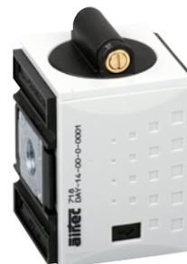
Anfahrventil zum langsamen Druckaufbau in Druckluftsystemen. Die Betätigung erfolgt durch den Sekundärdruck. Nach Erreichen von 50% des Ausgangsdrucks schaltet das Ventil komplett durch. Die Füllzeit ist einstellbar.
