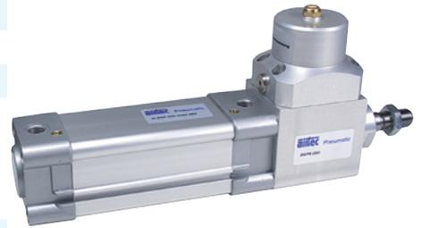
Doppeltwirkender Pneumatikzylinder, beidseitig mit einstellbarer, pneumatischer Endlagendämpfung. Mit Positionserkennung zur berührungslosen Stellungsabfrage mit Zylinderschaltern.
