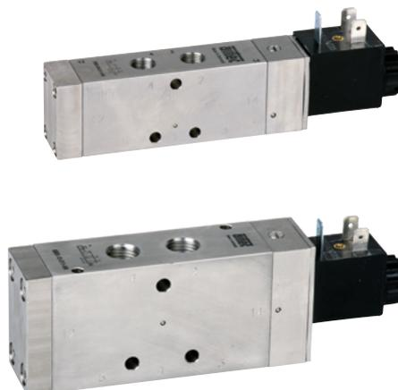
Elektrisch betätigtes Kolbenschieber-Ventil. Nach Zuschalten der Spannung wird das Ventil umgesteuert. Die Ventile sind mit einer rastenden Handhilfsbetätigung ausgestattet. Die Betätigung erfolgt mittels Schraubendreher.
