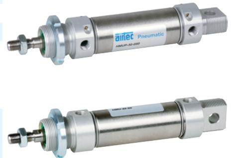
Doppeltwirkender Pneumatikzylinder mit Dämpfungsscheiben in den Endlagen und Positionserkennung zur berührungslosen Stellungsabfrage mit Zylinderschaltern. Der Zylinder ist auch mit einstellbarer, pneumatischer Endlagendämpfung lieferbar. Zylinderkopf und -boden sind mit dem Zylinderrohr durch Rollieren verbunden.
