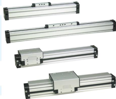
Doppeltwirkender kolbenstangenloser Pneumatikzylinder, beidseitig mit einstellbarer, pneumatischer Endlagendämpfung und Positionserkennung zur berührungslosen Stellungsabfrage mit Zylinderschaltern.
